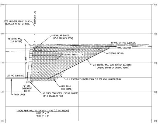
\*BENCH LENGTH SHOWN IS FOR MAX WALL HEIGHT. BENCH LENGTH TO EQUAL WALL BLOCK DEPTH PLUS  $\frac{1}{2}$  THE WALL HEIGHT.
