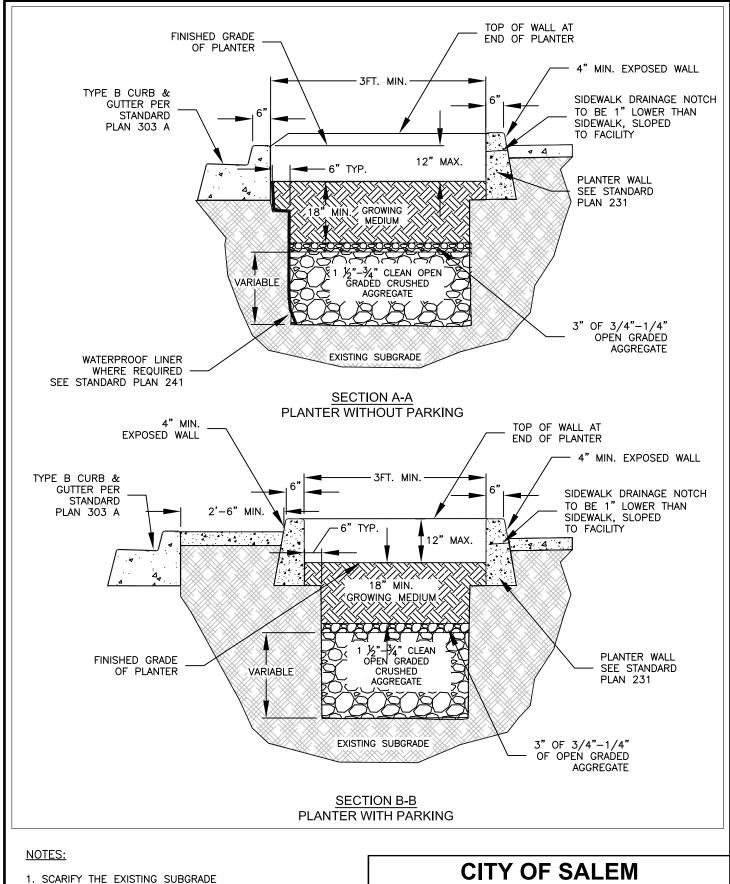
1. SCARIFY THE EXISTING SUBGRADE FOLLOWING THE INITIAL EXCAVATION AND BEFORE INSTALLING TOPSOIL OR ROCK
