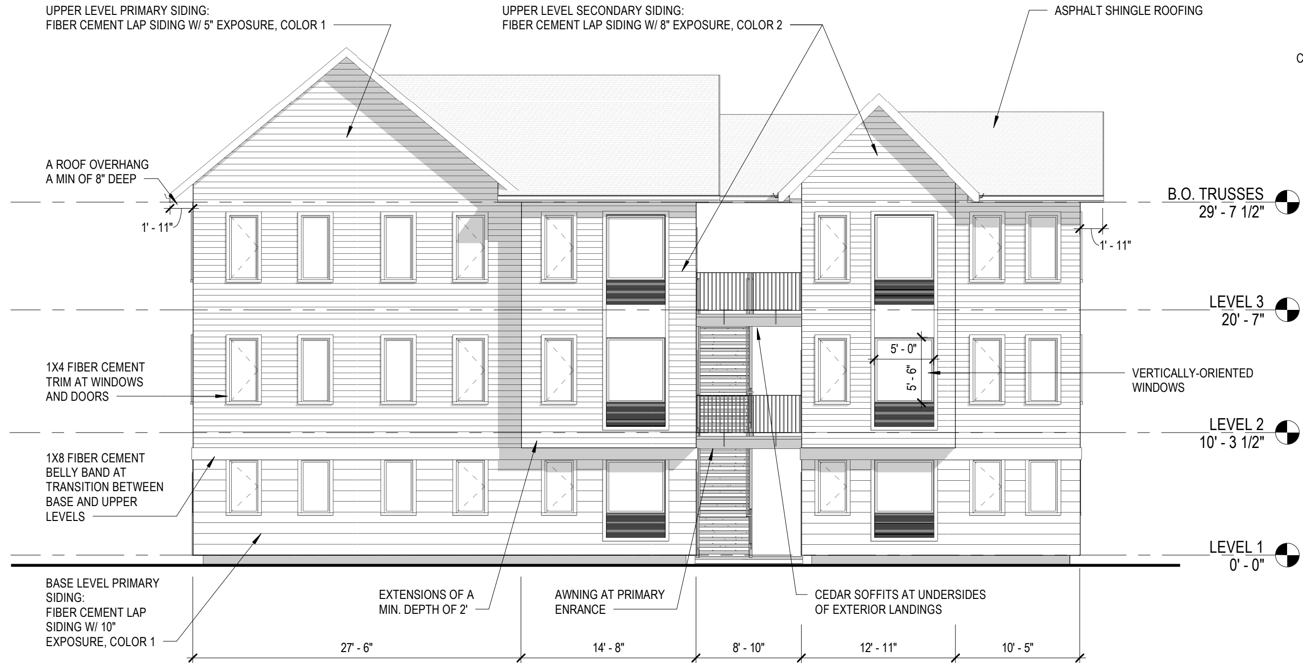
A31 1 FRONT ELEVATION - TYPE 1 SCALE: 1/8" = 1'-0"
