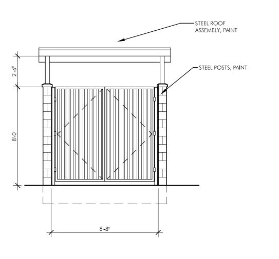
TRASH ENCLOSURE BACK ELEVATION
