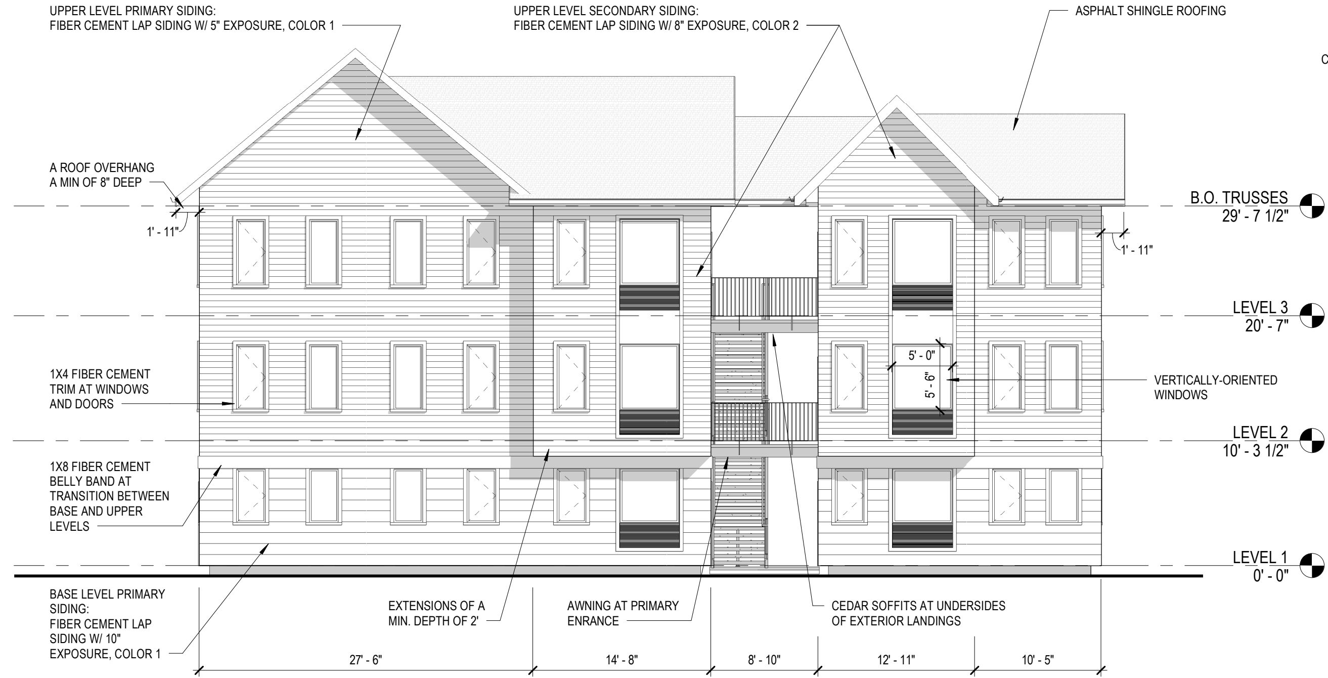
A31 1 FRONT ELEVATION - TYPE 1 SCALE: 1/8" = 1'-0"
